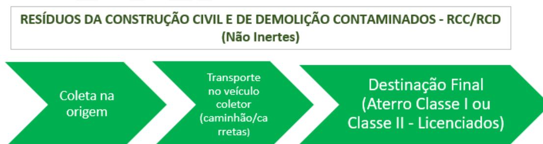
Figura 5.2: Fluxo de transporte de RCC/RCD
